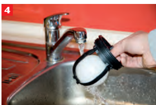
Rückstaeinheit und Dichtungen gründlich unter fließendem Wasser reinigen. Die Wassertemperatur darf nicht mehr als 50 °C betragen. Bitte keine chemischen und aggressiven Reinigungsmittel verwenden und nicht abkochen
